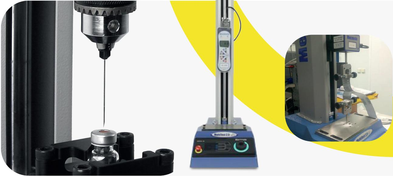
Відповідно до пункту **8.22** («Завершальний етап виготовлення стерильної продукції») проводиться **випробування тари на цілісність**. Скляні ампули, пакети в разі технології «видування-наповнення-герметизація» та контейнери малого об'єму ( $\leq 100$  мл), що герметизують способом запаювання, у **100 % випадків необхідно випробувати на цілісність**.
