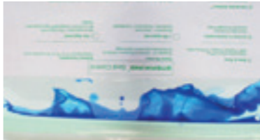
Рисунок 2. Мульти – тест. Качественный сварочный шов (прошел) слева, некачественный сварной шов (протекающий) справа.
